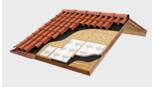
ISOLAMENTO NON PORTANTE ALL'ESTRADOSSO
