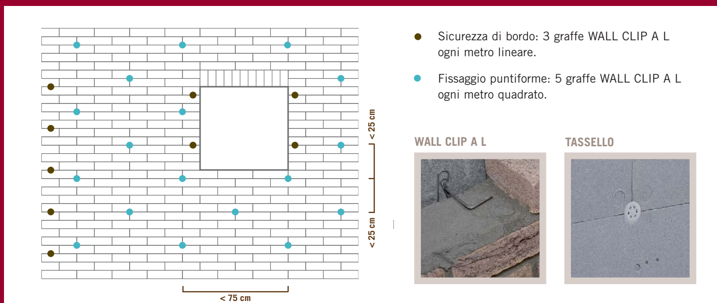
Schema di distribuzione dei graffaggi nel muro faccia a vista, come disposto dalla norma DIN 1053/90
